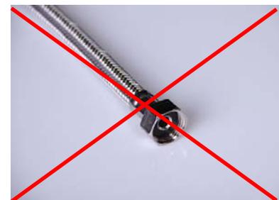
Die Ansaugschlauchleitung darf nicht knicken.
