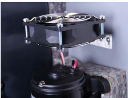
Der Lüfter kühlt die Pumpe durch einen gleichmäßigen Luftstrom. Falls kein Dauerbetrieb vorgesehen ist, kann der Lüfter auch elektronisch abgeklemmt werden. Dies spart ca. 6W Leistung ein. Falls dann dennoch mal die Pumpe im Dauerlauf mit hohem Gegendruck betrieben wird und sich die Pumpe zu stark erwärmt, schaltet der Pumpentempersensor die Pumpe ab. (Die Pumpe schaltet sich bei nach einer Abkühlzeit selbständig wieder ein.)
